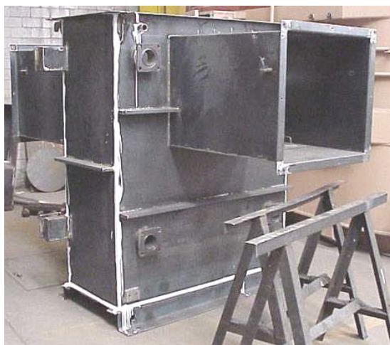
Fig. 3.11 Tanque soldado y sin granalla
