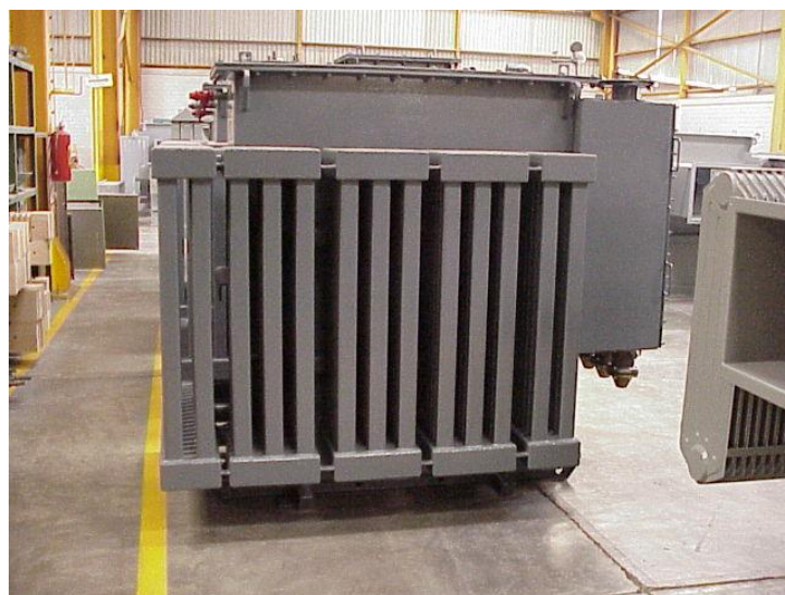
Fig. 2.6 Transformador tipo sumergible
