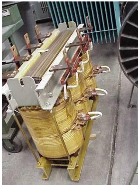
Fig. 2.8 Transformador tipo seco
