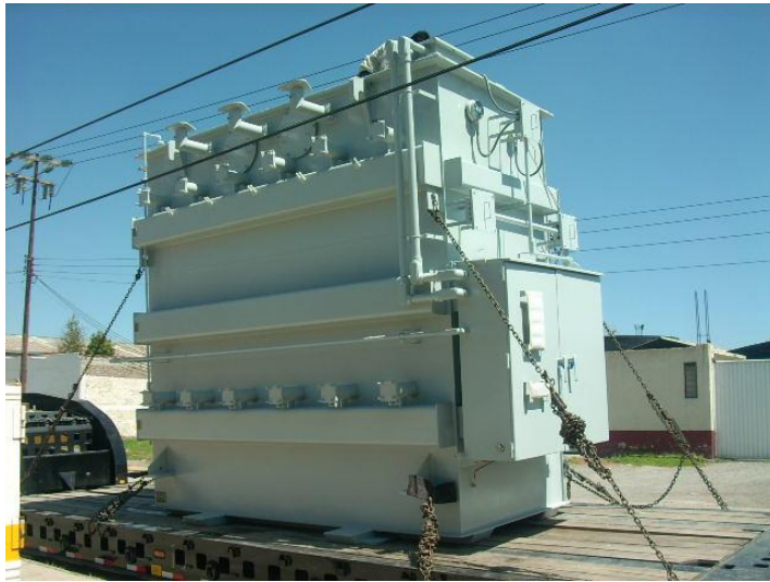
Fig.2.7 Transformador de potencia
