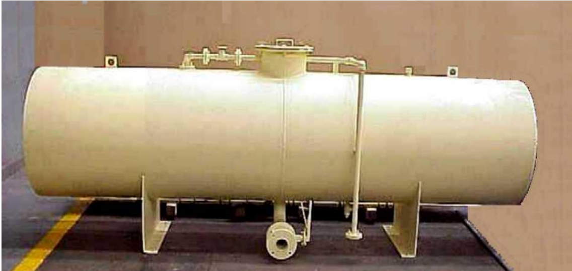
Fig. 1.16 Vista de frente de tanque conservador.
