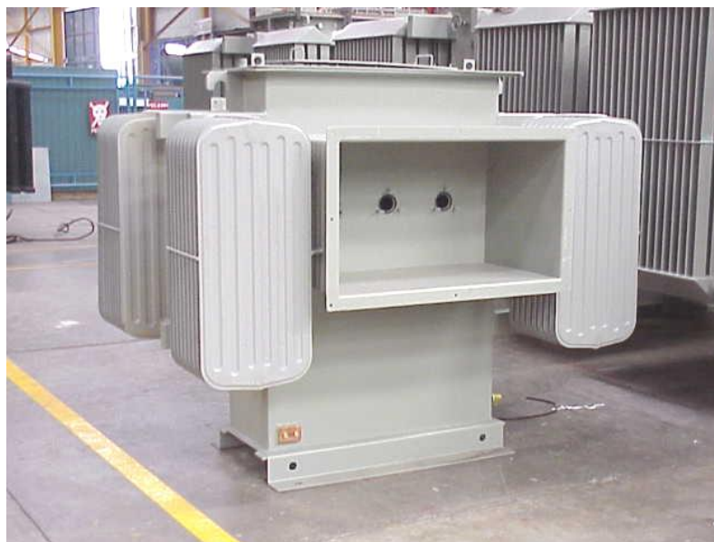
Fig. 3.15 Tanque con radiadores y pintado
