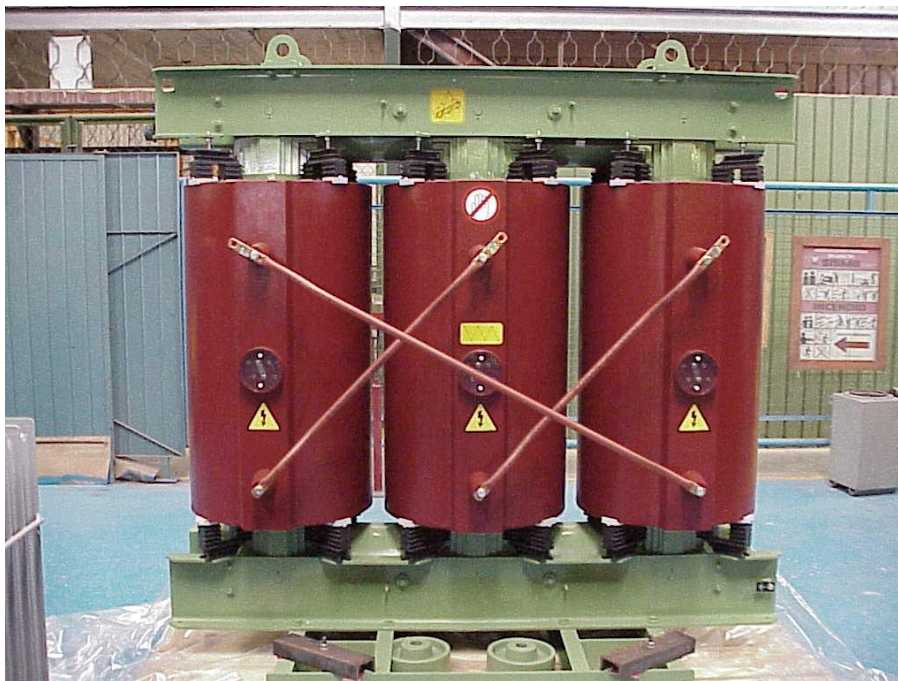
Fig. 2.2 Transformado tipo encapsulado.
