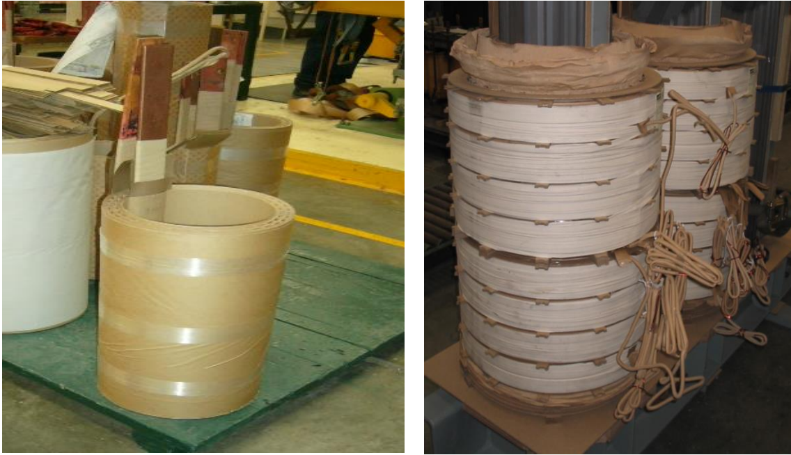
Fig. 1.7 Vista general de una bobina de baja y alta tensión en forma cilíndrica.
