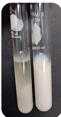
**Figura 2.** Prueba de hidrólisis de caseína positiva (izq.) y negativa (der.) (Fuente: Propia).
