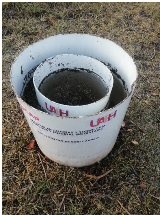
Figura 8. Infiltrómetro de doble anillo
