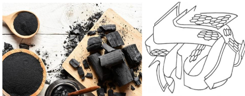
Figura 2.10 | Carbón activado (izquierda) y esquema estructural (derecha). Fuente: https://www.cocooncenter.es/rincon/el-carbon-vegetal-sus-beneficios-en-nuestra-salud.html
