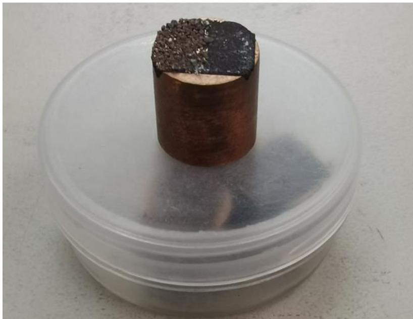
*Figura 7. Barra de cobre cubierta en la cara superior por cinta de grafito (modelo de montaje para todas las muestras).*
