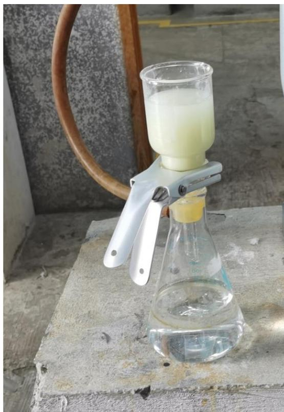
Figura 6. Ensamble para recuperación de la zeolita 13X intercambiada, utilizando vacío y papel microporo.
