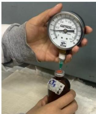
Figura 18. Lectura de presión de gas producido en fermentación.
