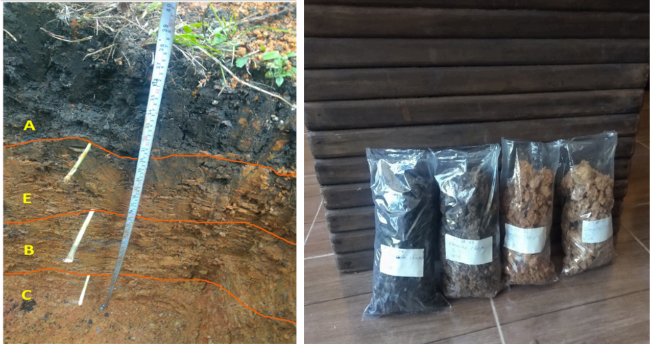
Figura 16. Obtención de muestras de suelo para determinar la concentración de carbono en sistema agroforestal con café en Chenalhó, Chiapas.
