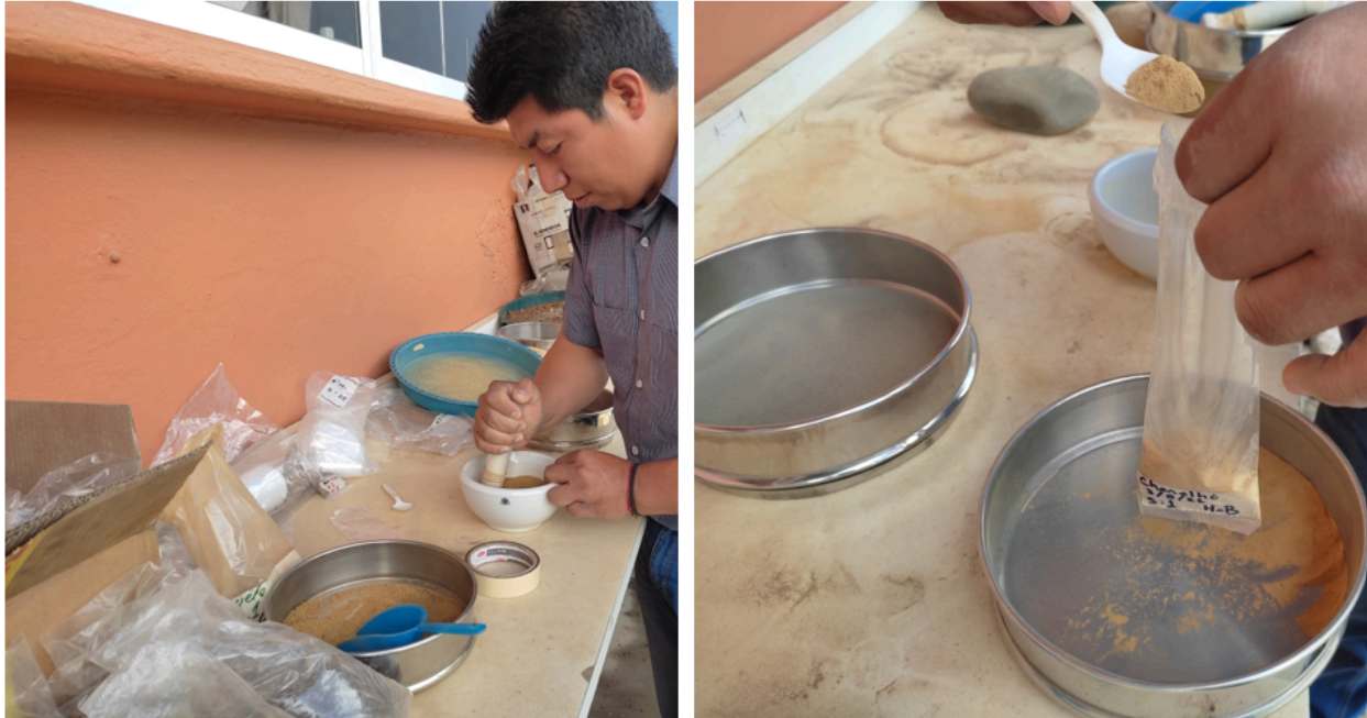
Figura 19. Pulverización y tamizado de las muestras de suelo para introducir al analizador de carbono elemental Thermo Scientific FLASH 2000 C-N Soils Analyzer.
