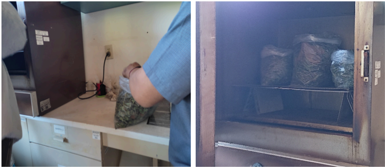
Figura 17. Secado de muestras de diferentes componentes de árboles, arbustos, herbáceas en la estufa de secado a 65 °C hasta alcanzar peso constante.
