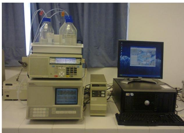
**Figura 10.** Equipo para Cromatografía Líquida de Alta Resolución (HPLC)
