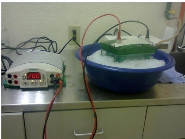
**Figura 9.**Equipo de electroforesis Mini-PROTEAN Tetra cell, BIO-RAD
