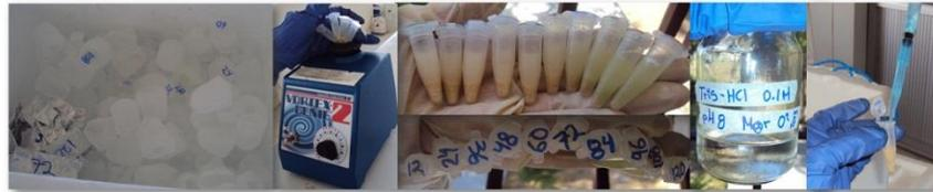
Se añadió 1ml de solución de extracción (Tris-HCl 0.1 M pH8) y se agitó por 10 min (2 min en hielo y 2 min en agitación hasta completar los 10 min)
