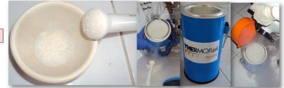
Se molieron las muestras añadiendo nitrógeno líquido con un mortero con pistilo
