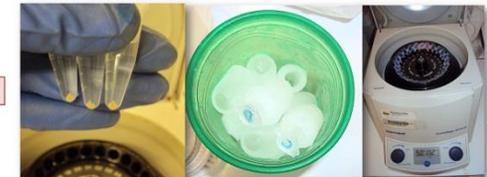
Se centrifugó por 5 min a 13,200 rpm (1 min en centrífuga y 1 min en hielo hasta completar los 5 min)
