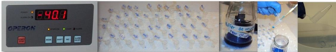
Se evaporó la acetona (aproximadamente 1 hora) y se adicionó 92 µl de amortiguador de muestra pH 6.8, se congeló a -40°C hasta cargar en los geles de poliacrilamida e iniciar la electroforesis
