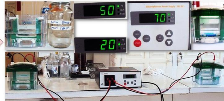
Se corrió a 50 V con 20 mA por 30 min, después se subió el voltaje a 70 V con 30 mA entre 3 y 4 horas aproximadamente
