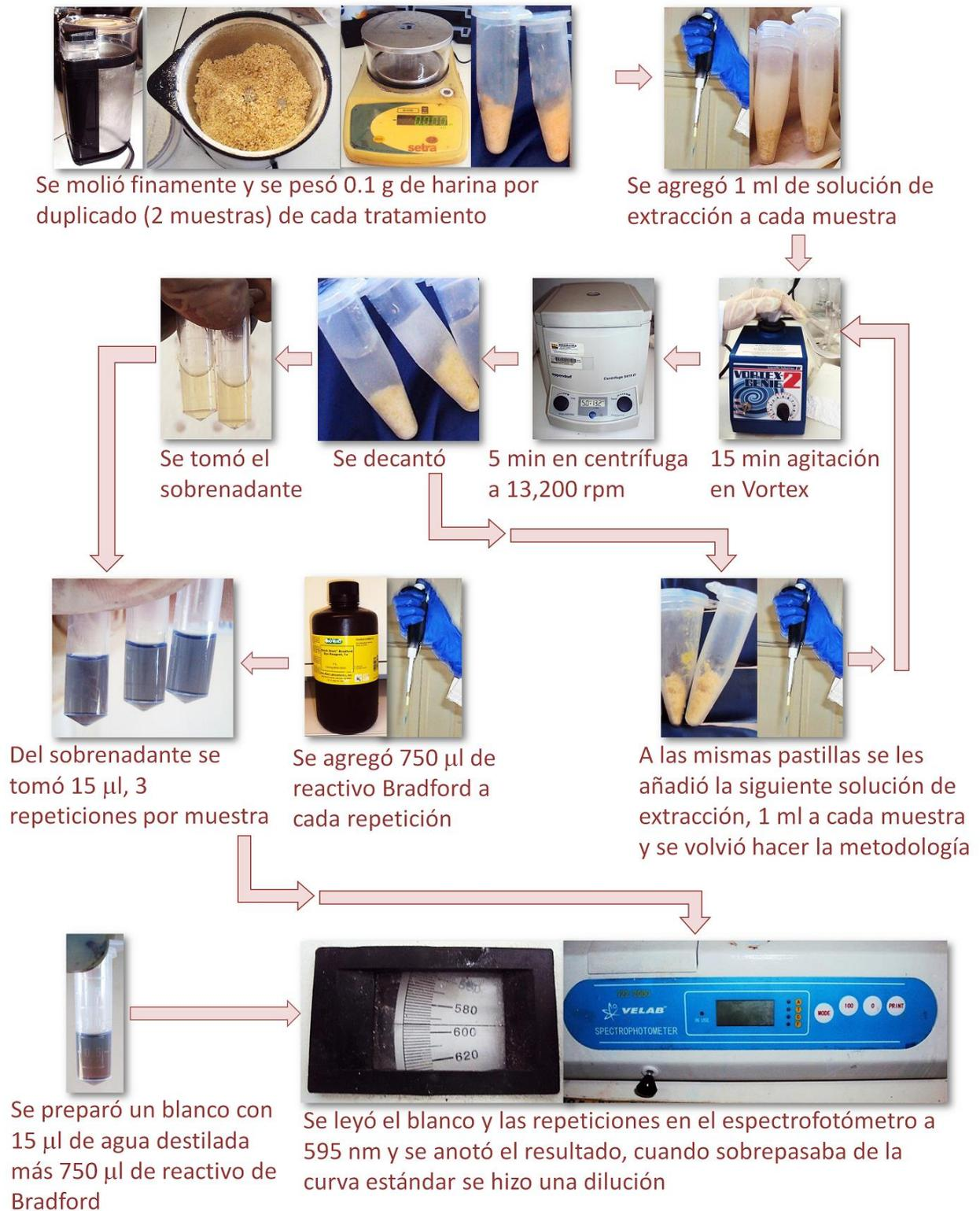
Figura 13. Esquema de preparación de muestra para medición de proteína por el método de Bradford.
