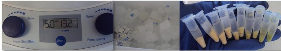
Se centrifugó por 5 min a 13,200 rpm (1 min en centrífuga y 1 min en hielo hasta completar los 5 min)
