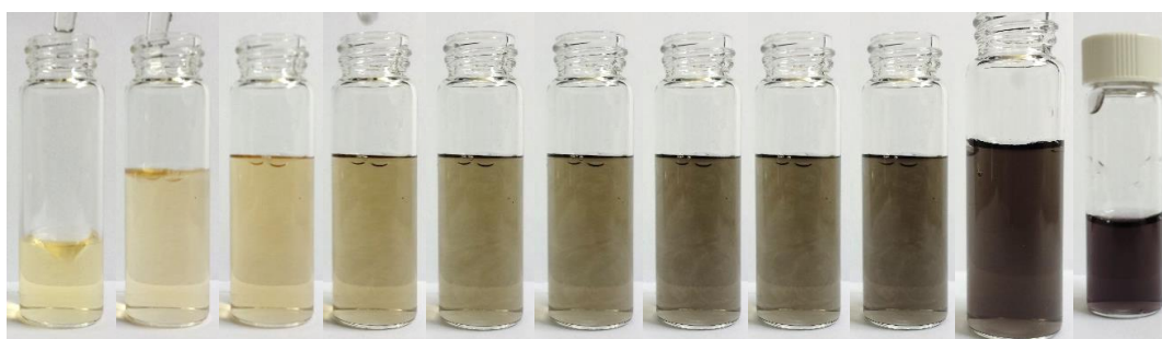
Figura 31. Evolución del color de la solución de nanopartículas de Au durante los primeros 60 segundos de la reacción.
