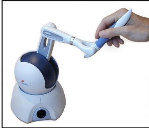
Figura 6.4: Dispositivo háptico PHANTOM OMNI [123].
