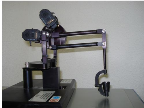
Figura 2.11: Dispositivo háptico PHANToM premium 1.0
