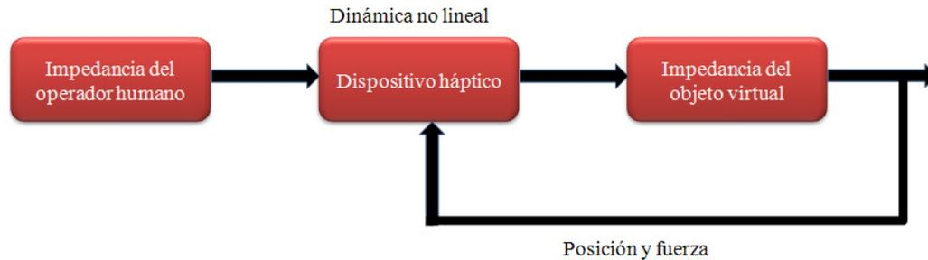
Figura 2.10: Diagrama a bloques de una interfaz háptica activa.
