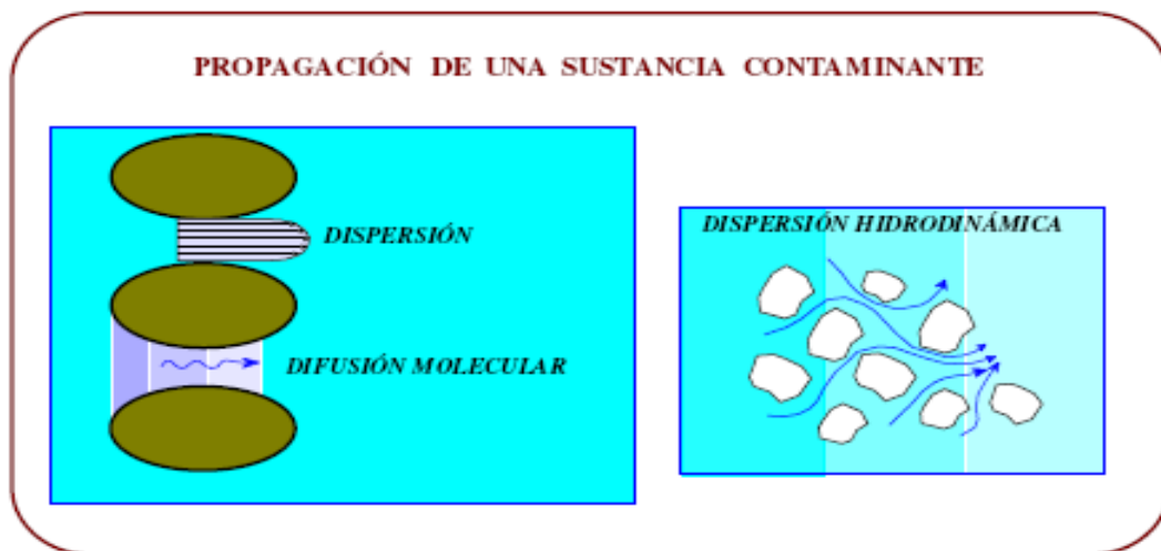
Figura 4. Fenómeno de dispersión hidrodinámica
