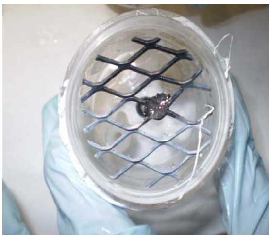
Figura 53. Depósitos blancos sobre el cátodo durante los experimentos de electroremediación de los suelos MCP17 y MCP31
