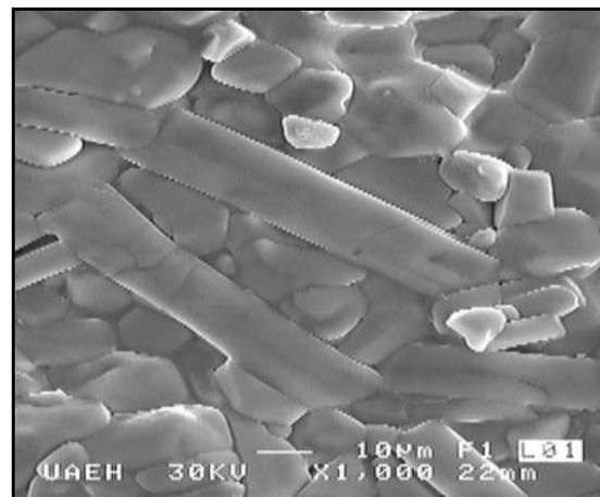
Figura 41. Micrográficas de superficies de fractura de los pellets obtenidos mediante el mecanismo de  $\text{BaTi}_{1-5x}\text{Nb}_{4x}\text{O}_3$  por la ruta de titanato de bario.
