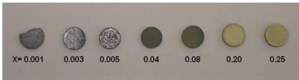
Figura 85. Cambio en la coloración de los pellets debido a la adición de Nb<sup>5+</sup> mediante el mecanismo de BaTi<sub>1-x</sub>Nb<sub>x</sub>O<sub>3</sub> por reacción en estado sólido.
