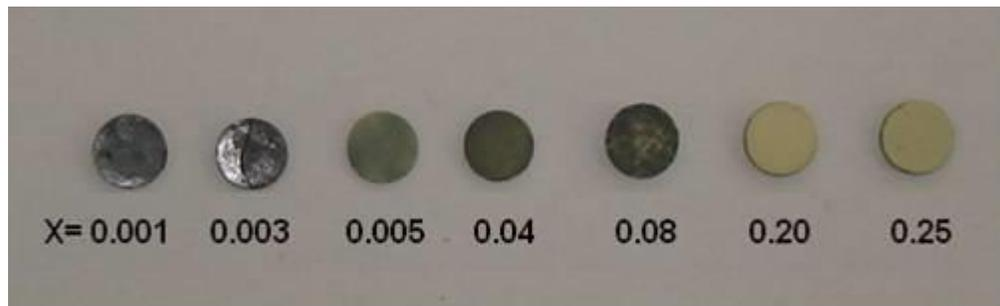
Figura 69. Variación de coloración de los pellets debido a la adición de  $\text{Nb}^{5+}$ .
