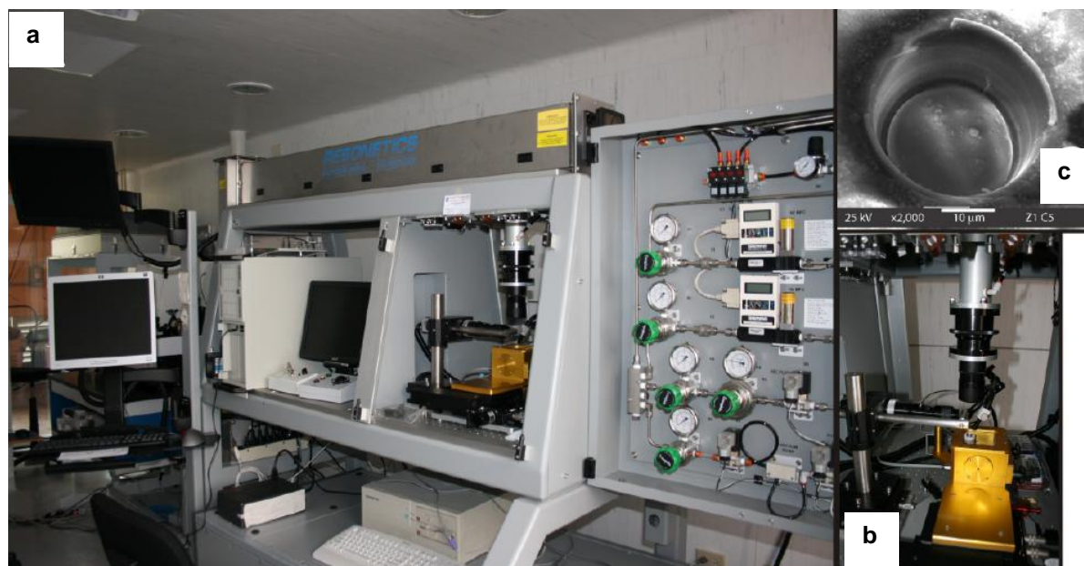
Fig. 2.5. Equipo de LA-ICP-MS del Centro de Geociencias, UNAM. (a) Vista general del equipo. (b) Celda de ablación y su cono interno de ablación. (c) Ejemplo del cráter de ablación. Tomado de Duque (2010).
