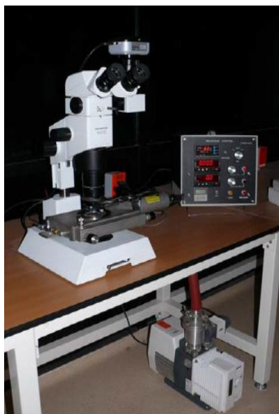
Fig. 2.4. Platina de cátodoluminiscencia acoplada a una lupa binocular y a una cámara digital, ubicada en el Laboratorio de Fluidos Corticales del CGEO, UNAM.
