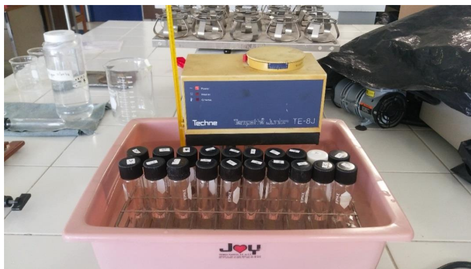
Figura 4.6. Cuba hidroneumática con controlador de temperatura.
