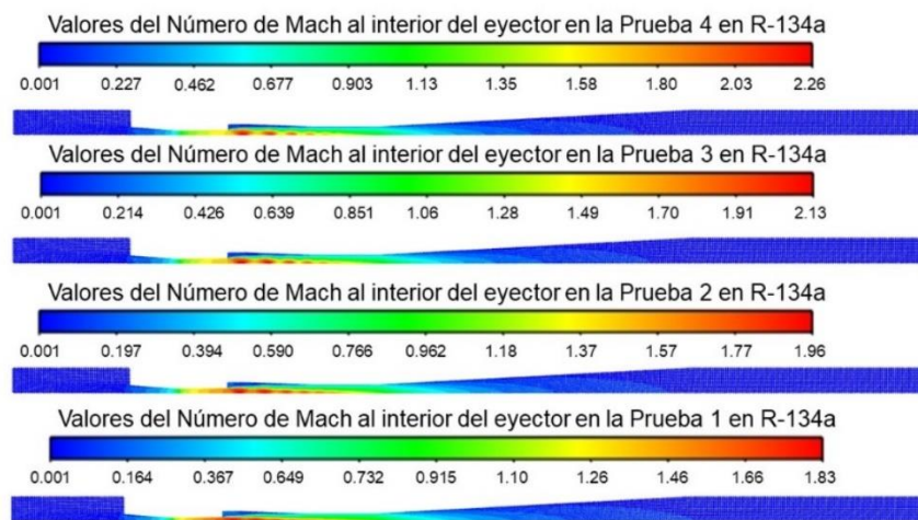
Figura 25. Número de Mach al interior del eyector en R-134a
