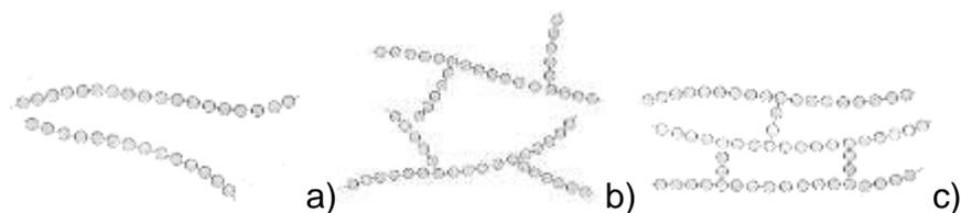
Figura 1.5 Tipos de cadenas poliméricas. a) Lineal b) Ramificada c) Red tridimensional.
