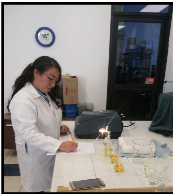
Figura 4.7. Determinación de nitrógeno amoniacal (NH 4 + ) por espectrofotometría de absorción de radiación visible.
