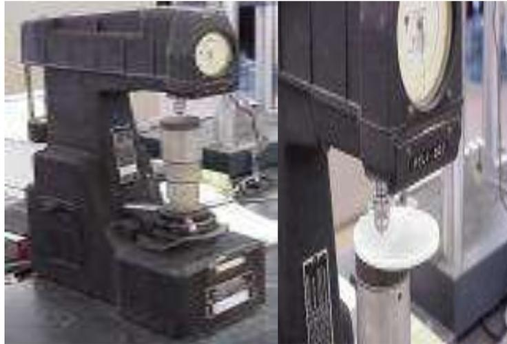
Figura 2.9. Muestra del funcionamiento del ensayo Rockwell. El ensayo se realiza en una máquina especialmente diseñada que aplica la carga a través de un sistema de pesas y palancas.
