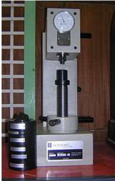
Figura 2.7 Durómetro, instrumento utilizado para medir la dureza de los materiales.
