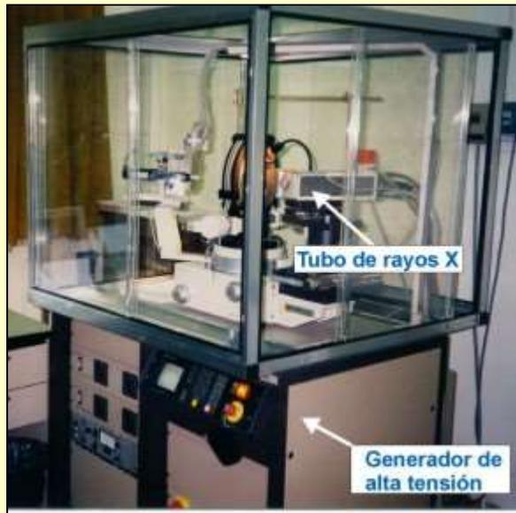
Generación de rayos X en un laboratorio de Cristalografía
