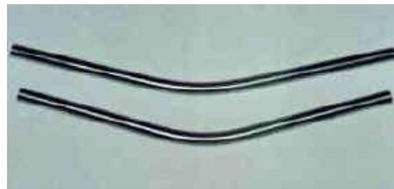
Figura 2.6. Flexión de materiales frágiles: Probeta sometida a Flexión.
