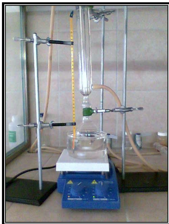
Figura 4.2. Dispositivo experimental para la síntesis de la manganita por el método poliol.
