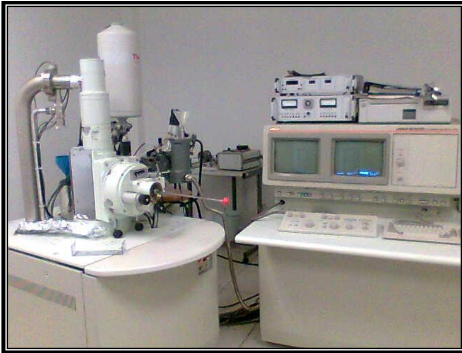
Figura 4.5. Microscopio electrónico de barrido (MEB) JEOL-JSM 6300.
