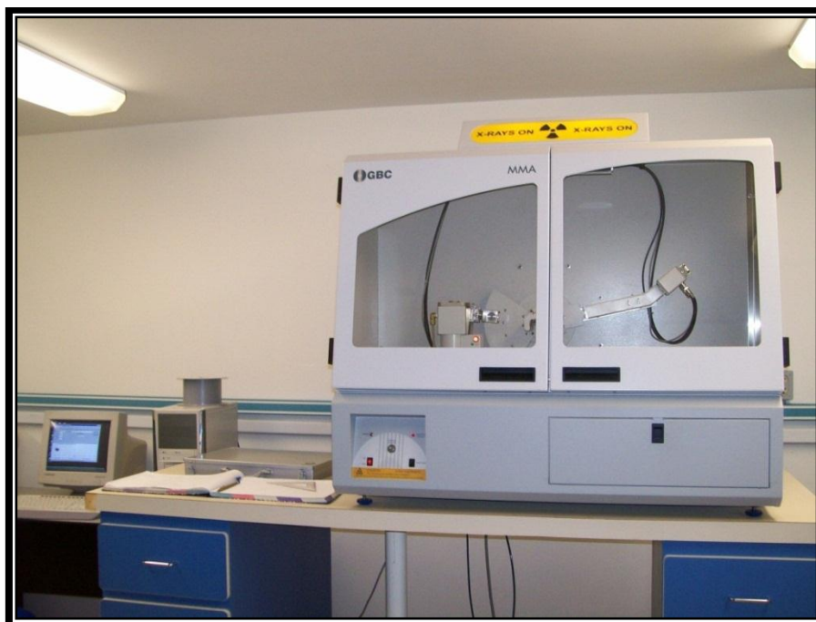
Figura 4.6. Difractómetro de rayos X marca GBC con radiación \text{CuK}\alpha .
