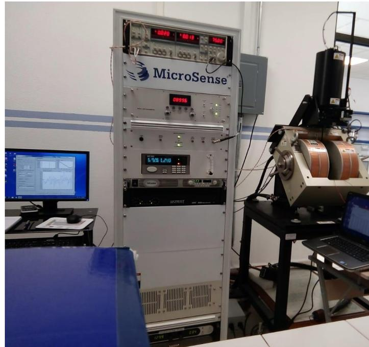
Figura 3. 31 Magnetómetro de muestra vibrante.
