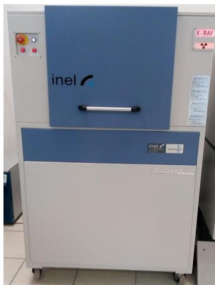
Figura 3. 25 Difractómetro de Rayos X.
