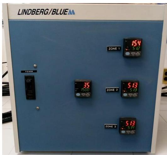
Figura 3. 14 Panel de Control de calentamiento.
