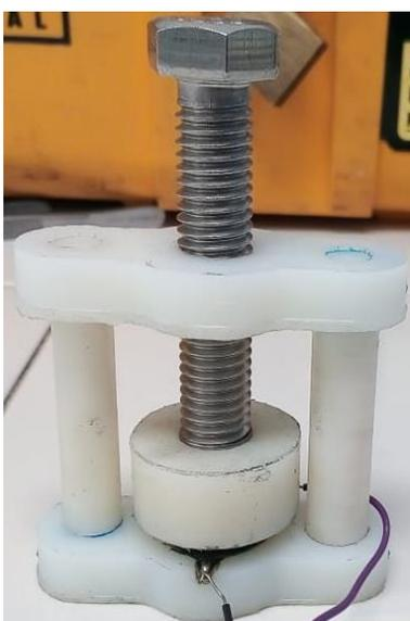
*Figura 3. 30 Porta muestras para Medidor LCR*
