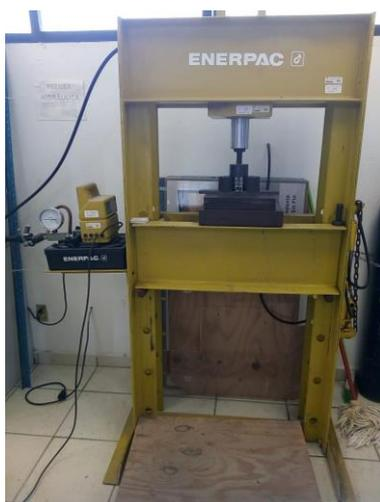
*Figura 3. 17 Prensa hidráulica.*
