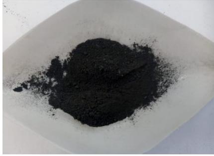
Figura 3. 6 Macro foto de la mezcla de polvos de  $Fe_2O_3$  y  $CoO$  sometido a molienda de alta energía durante 5 horas para obtener  $CoFe_2O_4$
