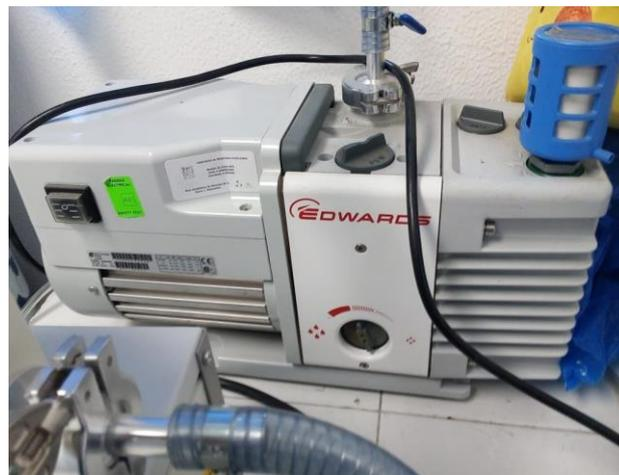
*Figura 3. 22 Bomba de vacío de Sputter SC7620.*
