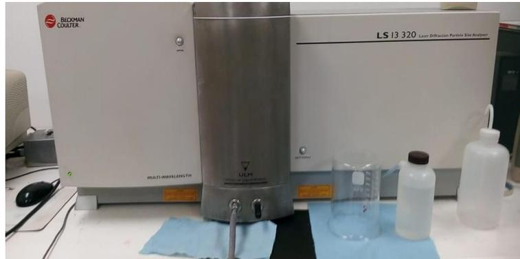
*Figura 3. 26 Analizador de tamaño de partículas por difracción láser.*
