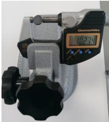
*Figura 3. 11 Micrómetro digital.*
