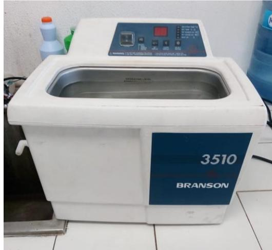
*Figura 3. 18 Agitador Ultrasónico.*
