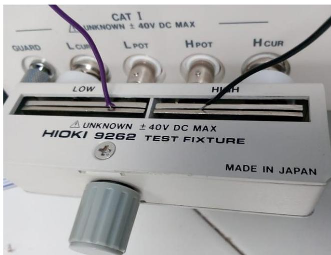
*Figura 3. 29 Adaptador 4 a 2 para Medidor LCR.*
