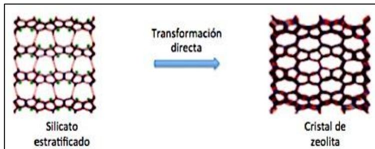
**Figura No. 11** Transformación directa de silicatos estratificados en zeolitas por condensación de silanoles o grupos hidroxilos de la alúmina (Suib, 2013).
