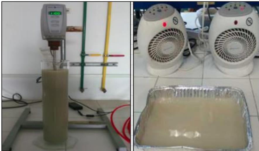
**Figura No. 16** Separación gravimétrica a diferentes tiempos de sedimentación.
