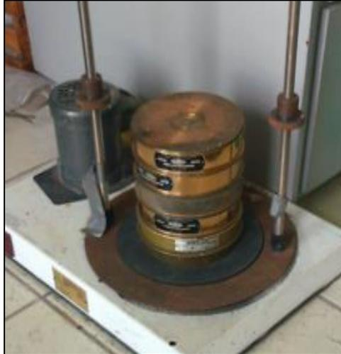
**Figura No. 14** Tamizador *Rotap*: mallas 25, 60, 80 y 100.
