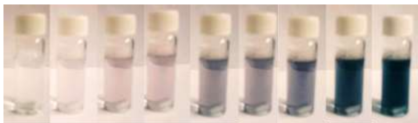
Figura IV.12 Evolución del color de la solución de nanorodillos de Au estabilizados con la mezcla de surfactantes CTAB-SDB durante los primeros 2 minutos.
