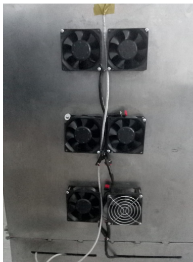
Figura 2.12: Ventiladores encargados de transferir el calor de las resistencias
