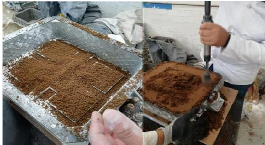
Figura 18. Apisonamiento de la arena dentro de la caja de moldeo y modelo.
