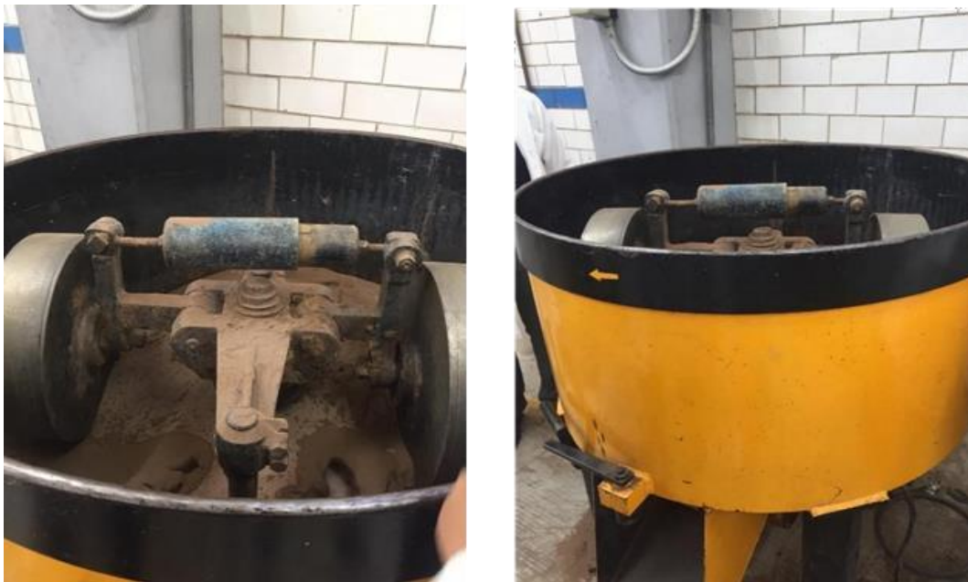
Figura 17. Preparación de la mezcla de moldeo en verde con molino chileno.
