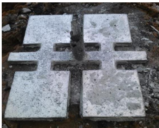
Figura 20. Placas obtenidas de la aleación Ni-Fe-Cr-Mo preparada.
