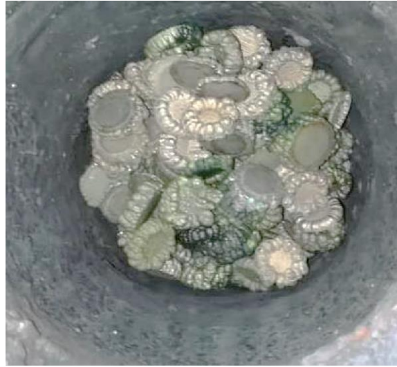
Figura 15. Materia prima de cargada en horno de inducción.
