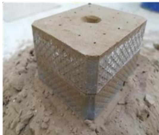
Figura 19. Molde elaborado y listo para el vaciado.
