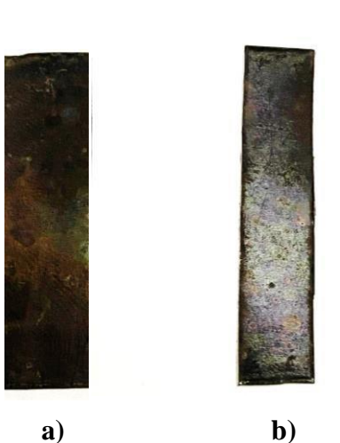
Figura 13. Imagen de los electrodos DSA preparados: a) Ti/RuO 2 y b) Ti/IrO 2 .
