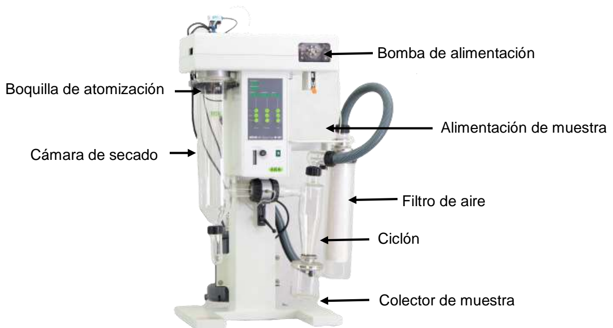
Figura 4. Esquema general del secador por aspersion de laboratorio Buchi B 191 Labortechnik AG (Flawil, Suiza).
