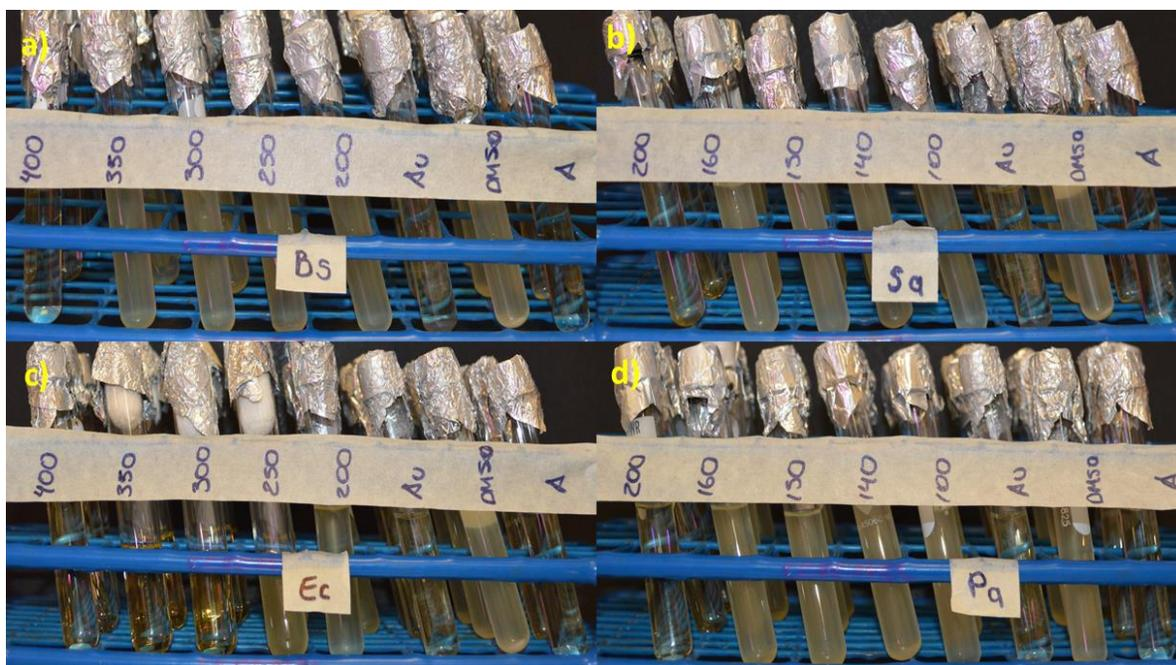
**Figura VIII.15.** Prueba final para determinar MIC en NHC-Au(I) (4a)
