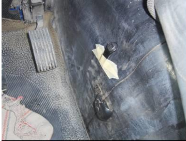
Figura 22. Colocación del Termistor en la tapa interior motor lado izquierdo (piloto).
