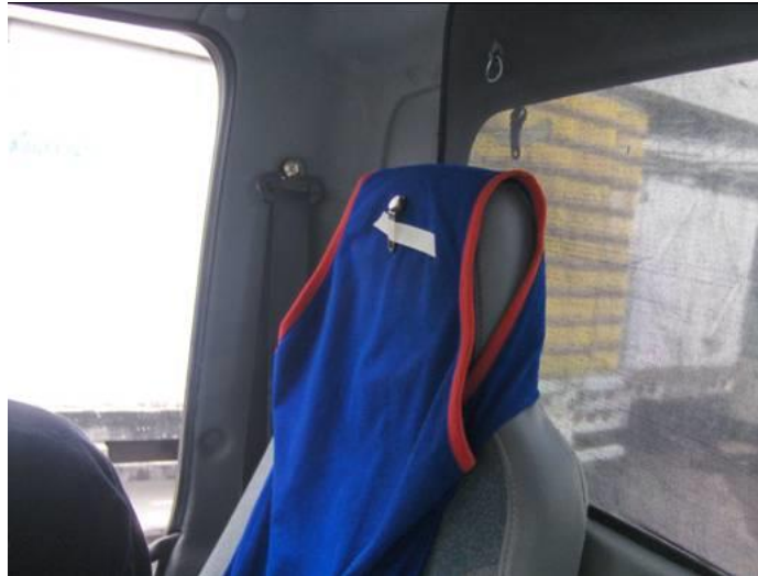
Figura 19. Colocación del termistor en el medallón cabina zona superior derecha y asiento del copiloto zona superior.
