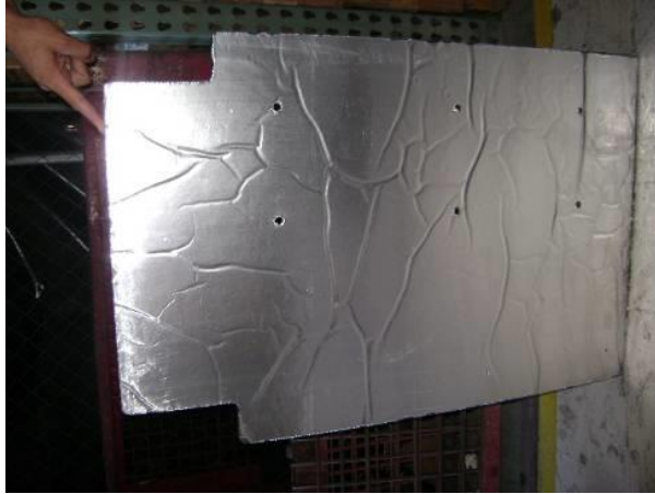
Figura 29. Placa protectora de aluminio de alta deflexión al calor
