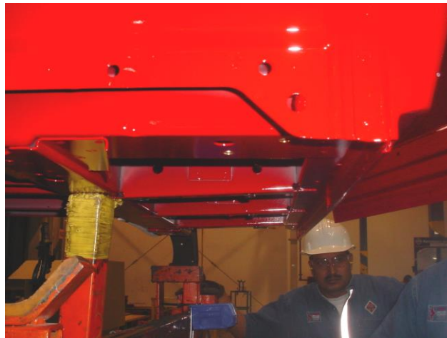
Figura 43. Momento en el cual se posicionan los soportes de planta para levantar cabina y atornillar aislante térmico
