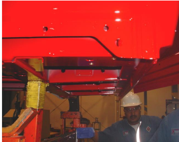
Figura 30. Posicionamiento de seguridad de la cabina en los soportes de planta
