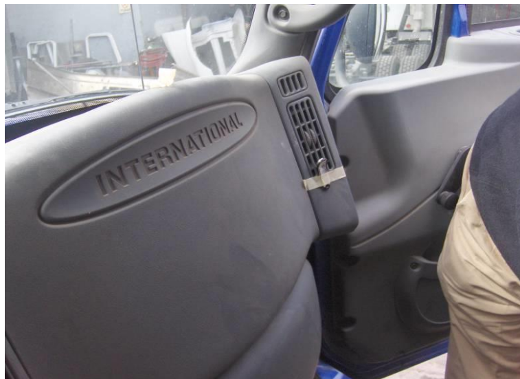
Figura 23. Colocación del termistor en la ventila A/A exterior derecha (copiloto).
