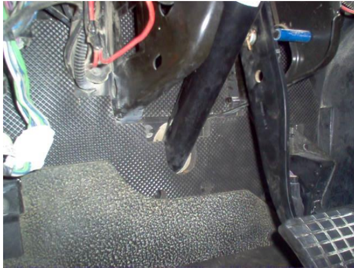
Figura 49. Arreglo en la pared de fuego, colocación de protección térmica.
