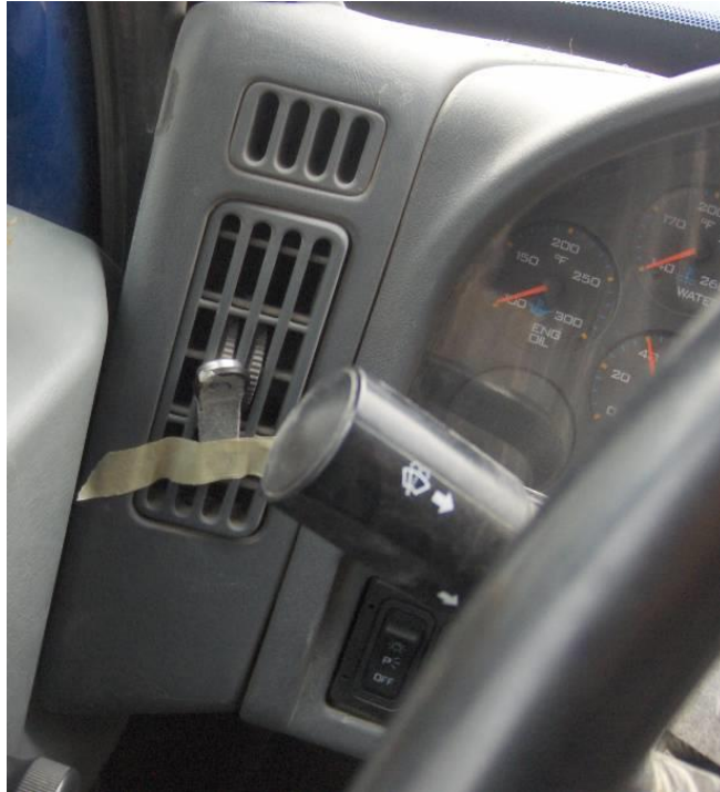
Figura 24. Colocación del termistor en la ventila A/A exterior izquierda (operador)
