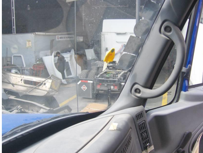
Figura 27. Colocación del dispositivo Anemómetro en el parabrisas del camión
