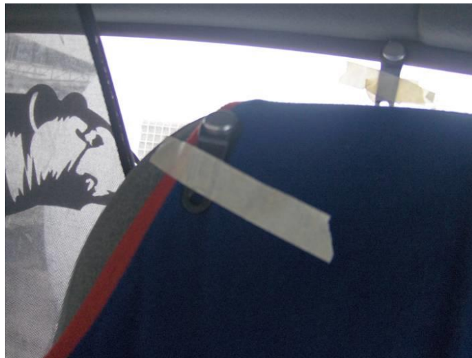
Figura 20. Termistor zona medallón y cabecera.
