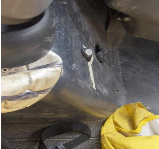
Figura 21. Colocación del termistor en la tapa interior motor lado derecho (copiloto)
