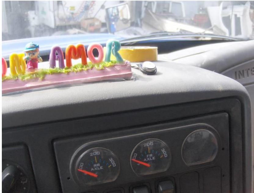
Figura 25. Termistor en tablero zona central superior
