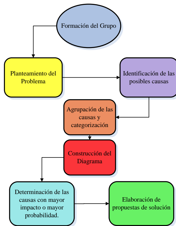
Figura 15. Procedimiento para realizar un análisis causa-efecto.
