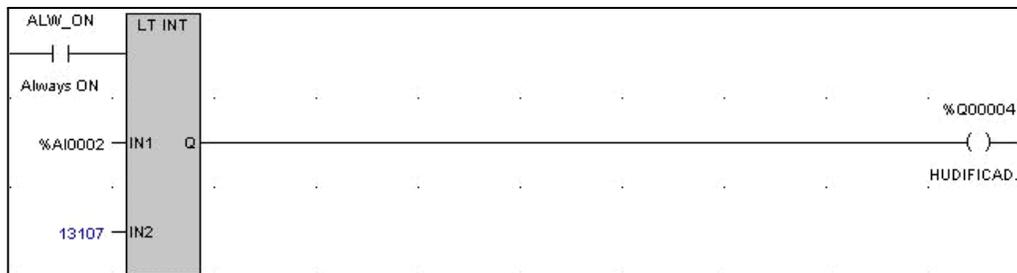
Figura 2.9: Control de Baja Humedad
