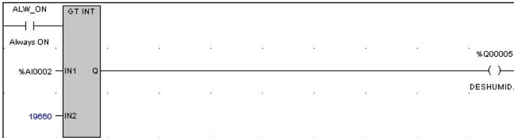
Figura 2.10: Control de Alta Humedad
