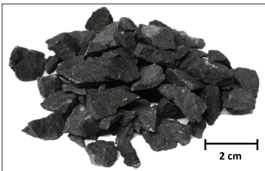
**Figura 4.3** Ejemplo de la fragmentación de muestras de lava realizado de manera manual, cuyos tamaños son menores a 2 cm. Equivalente a 1 kg de muestra.
