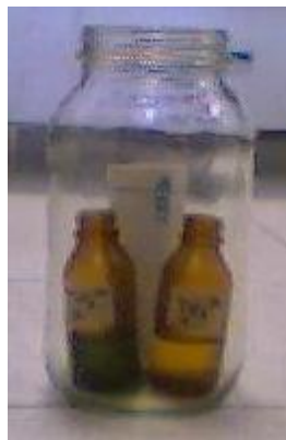
Figura 7. Jarra de incubación con el bloque de suelo y los viales para la captación de CO 2 y formas de nitrógeno inorgánico
