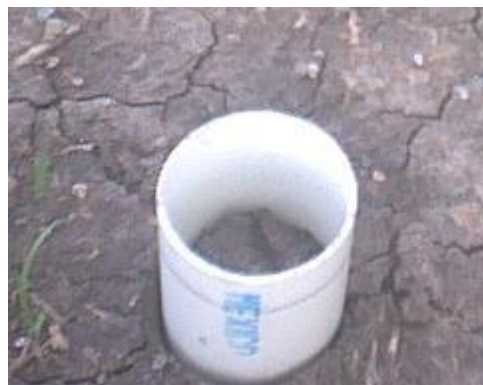
Figura 6. Recolección de bloques inalterados de suelo
