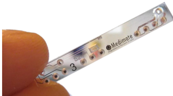
Figura 1.1: Microdispositivo fabricado por MEDIMATE que permite calcular la concentración de las sustancias específicas.
