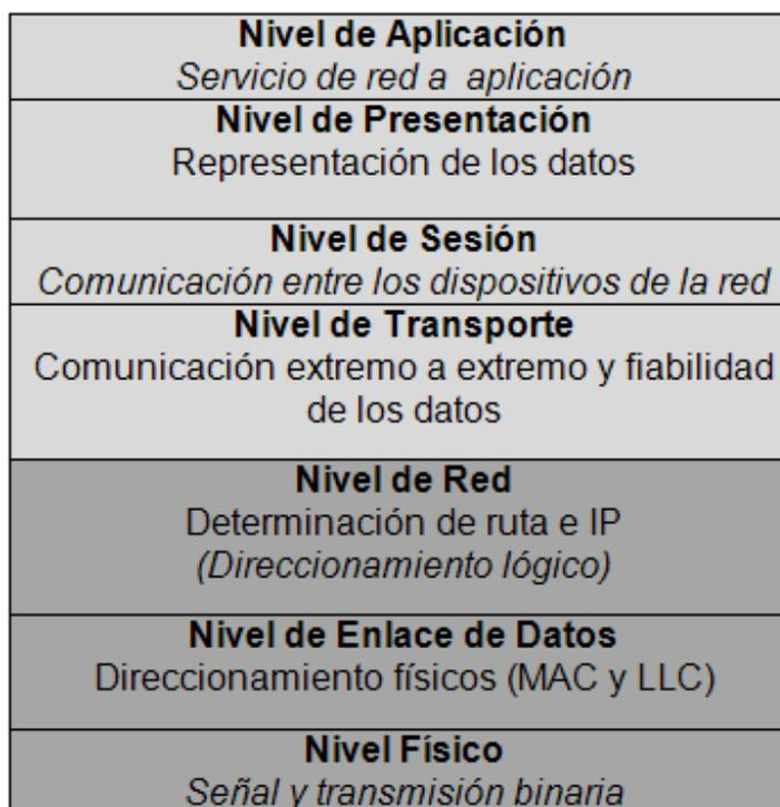
Figura 1: Capa del modelo OSI.
