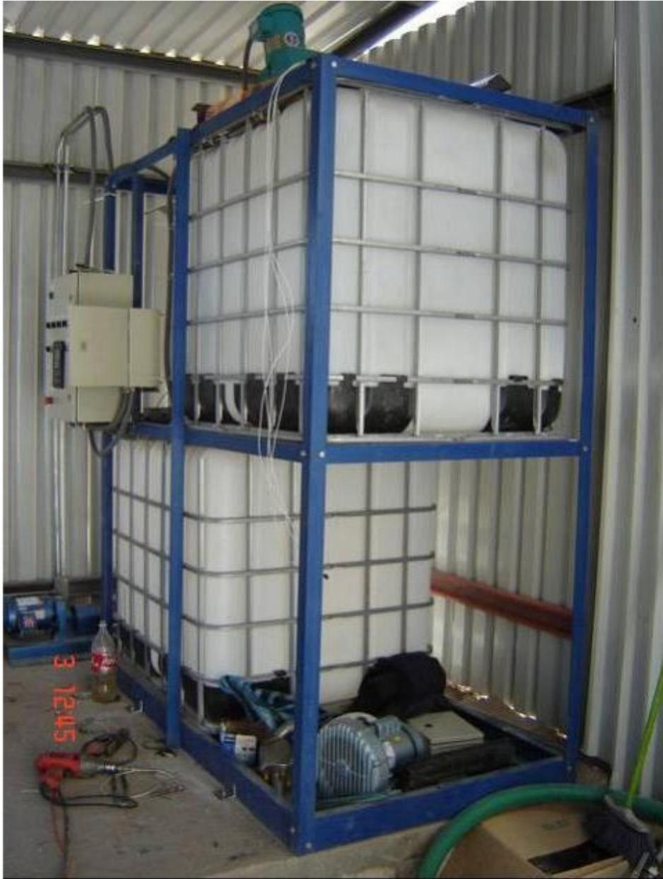
Fig. 2.16.- Instalación del sistema de preparación y dosificación de floculante .
