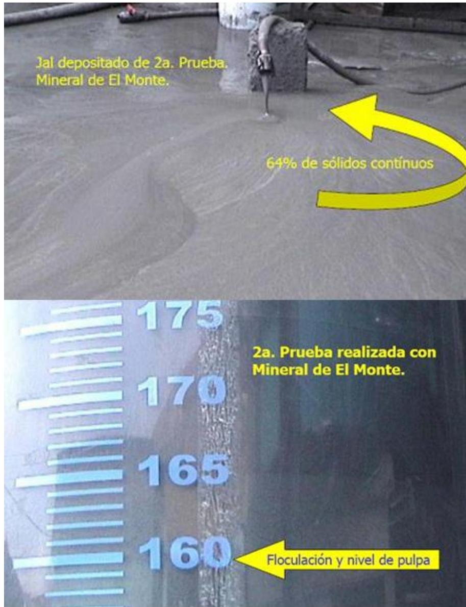
Fig. 1.13.- Descarga del tanque E- CAT con una concentración de 64% de sólidos y panorámica del efecto de la floculación en dicho tanque.
