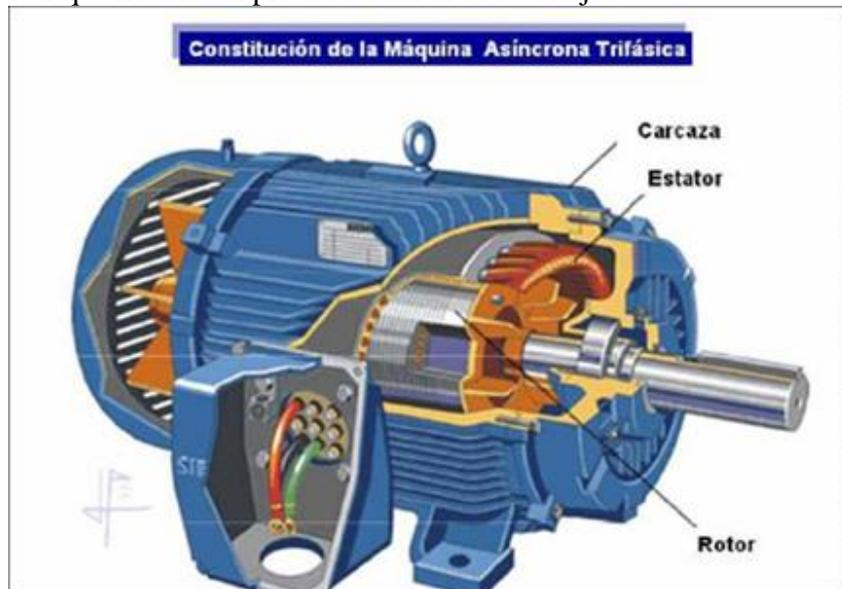
Fig. 3.4.- Partes constitutivas del motor de inducción trifásico.
