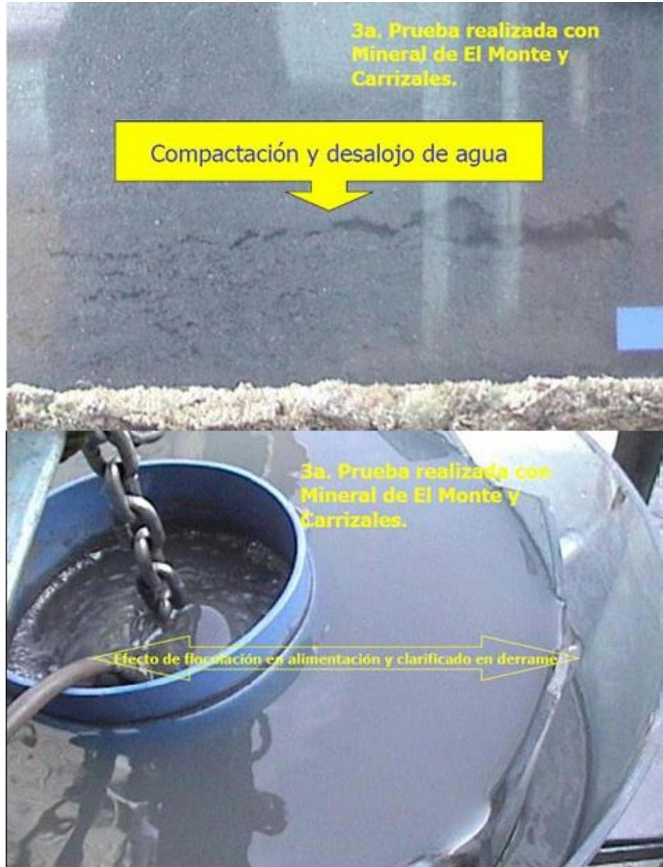
Fig. 1.15.- Zona de compresión y desalojo de agua ya con la mezcla de los dos minerales Monte y Carrizales además de la vista de la parte superior del E-CAT donde es agregado el floculante y el agua recuperada es canalizada hasta la tubería de derrame.
