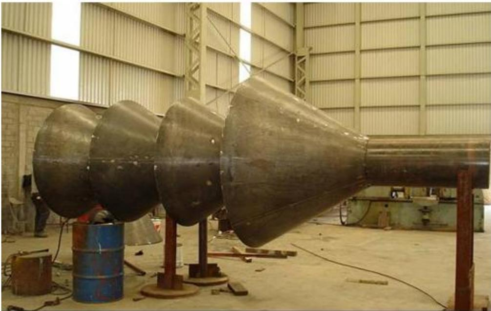
Fig. 2.7.- Cilindros clarificadores y la tubería con los conos de desecación.
