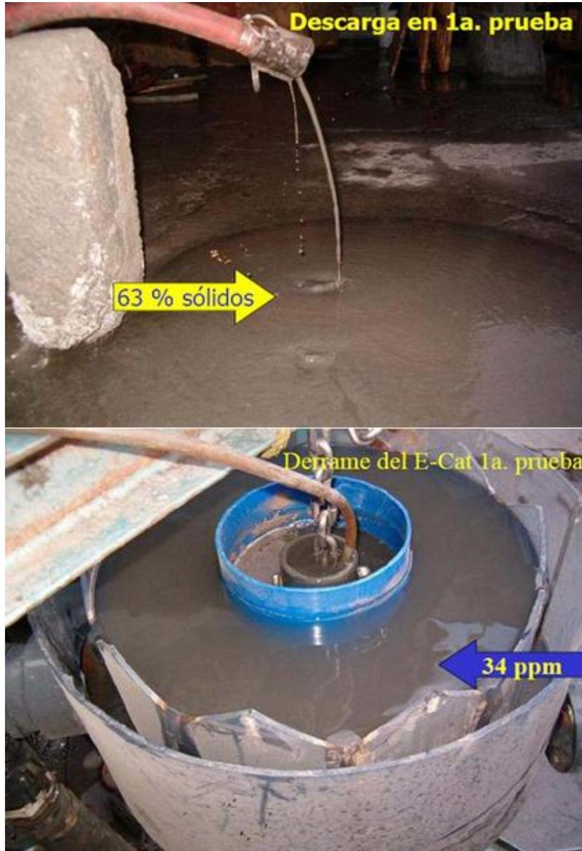
Fig. 1.10.- Descarga de sólidos del E- CAT con una concentración del 63% y vista superior del supernadante del tanque.
