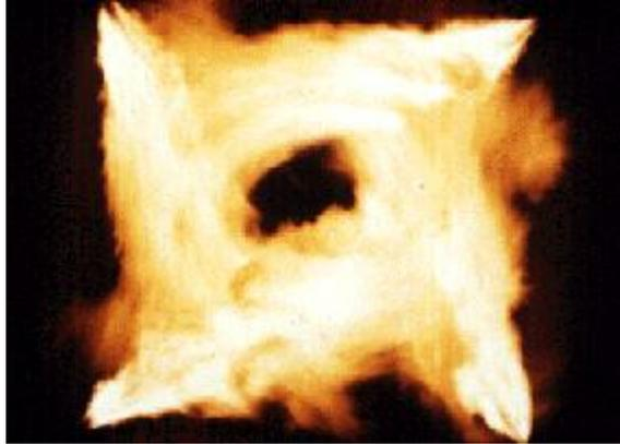
**Figura (42): Flama con exceso de gas**
