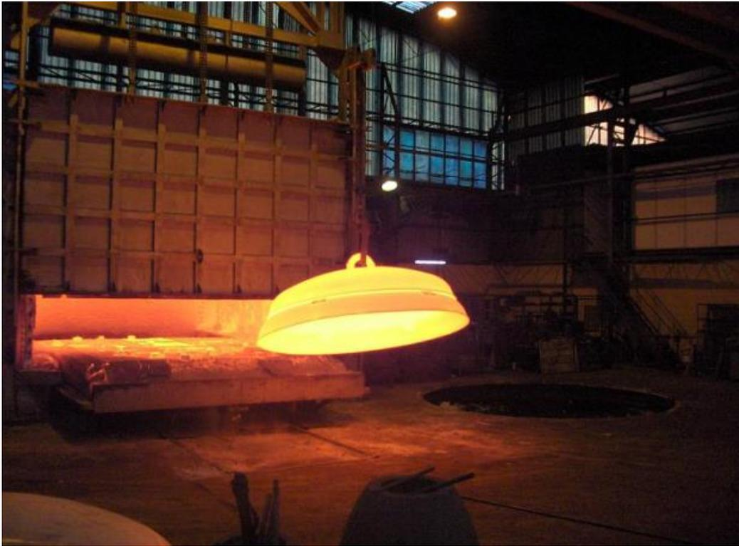
**Figura (50): Horno de tratamiento térmico de carro**
