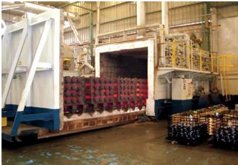
**Figura (51): Horno de tratamiento térmico de carro**
