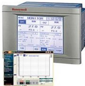
**Figura (2): Registrador de temperatura digital**
