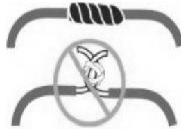
Fig. 4.2 Conexiones y aislamiento
