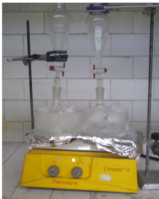
Figura III.3 Sistema de reacción para la síntesis del ácido (p-acrilóilaminofenilarsonico).
