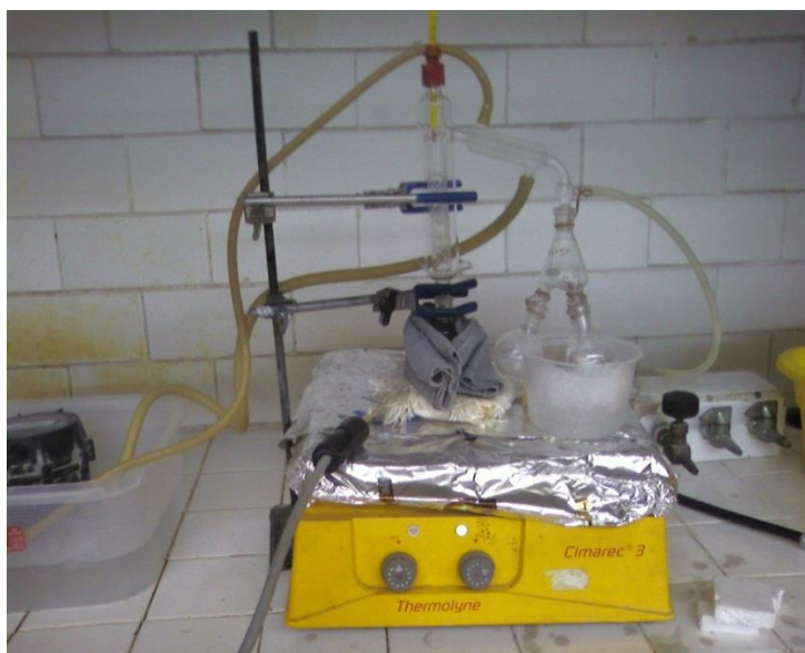
Figura III.1 Sistema de purificación del cloruro de acrilóilo.
