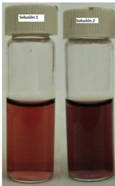
Figura IV.8 Suspensiones coloidales de nanopartículas de Au estabilizadas por: el polímero de menor peso molecular (a la derecha) y el polímero de mayor peso molecular (izquierda)
