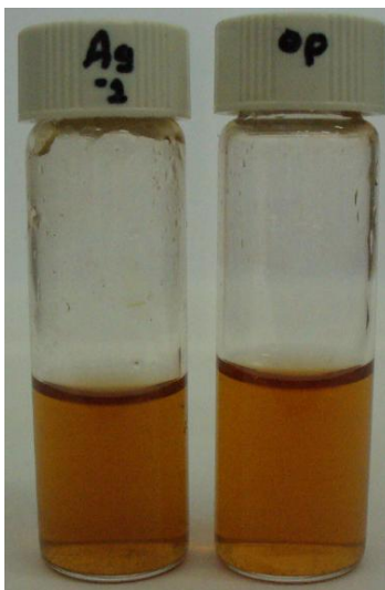
Figura IV.13 Suspensiones coloidales de nanopartículas de Ag estabilizadas por el polímero: de peso molecular \approx 38759 g/mol (derecha), y de peso molecular > 38759 g/mol (izquierda).
