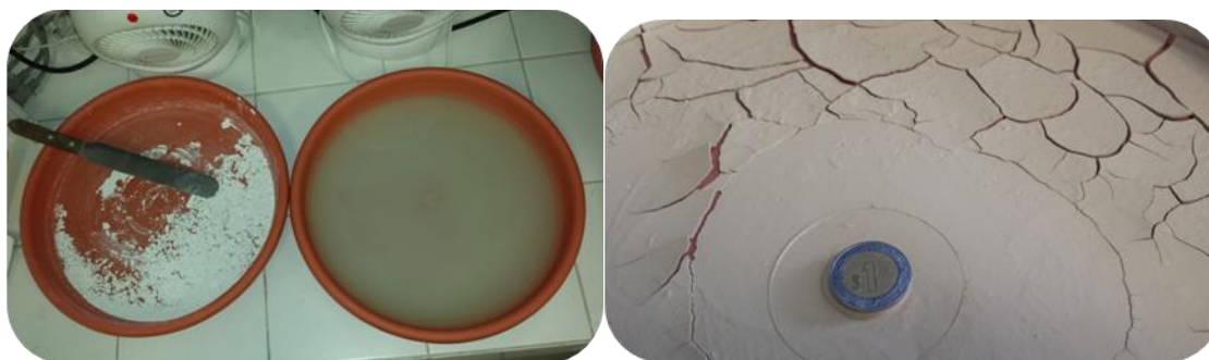
Figura 19. Evaporación de agua para la recuperación de mordenita.
