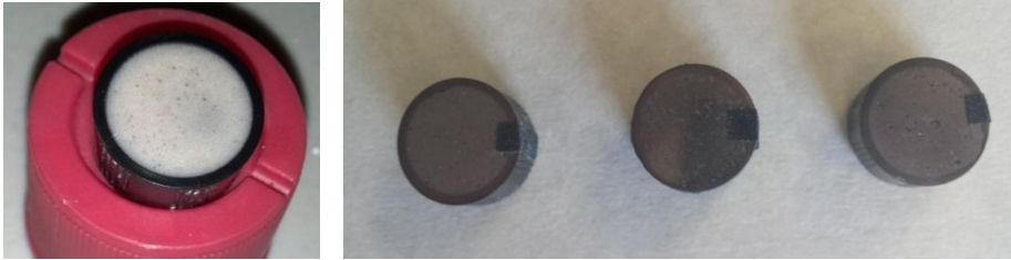
Figura 15. Muestras con resina epóxica y recubiertas con Au/Pd.
