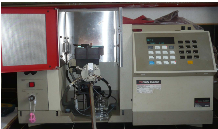
Figura. III.3. Espectrofotómetro de absorción atómica, Perkin Elmer Modelo 3100.
