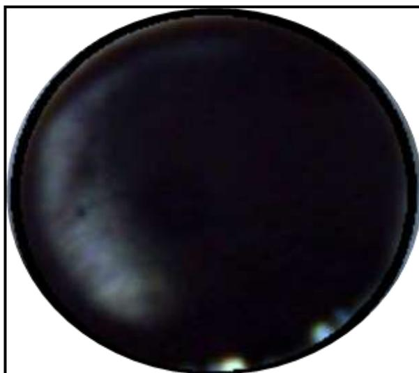
**Figura 3.1.** Imagen de la superficie de un electrodo de carbón vítreo con acabado espejo previo al proceso de electrodeposición de Pt sobre su superficie.
