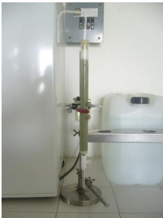
**Figura 12.** Columna empacada con la toba dacítica de Aguas Blancas tratada con MgO.
