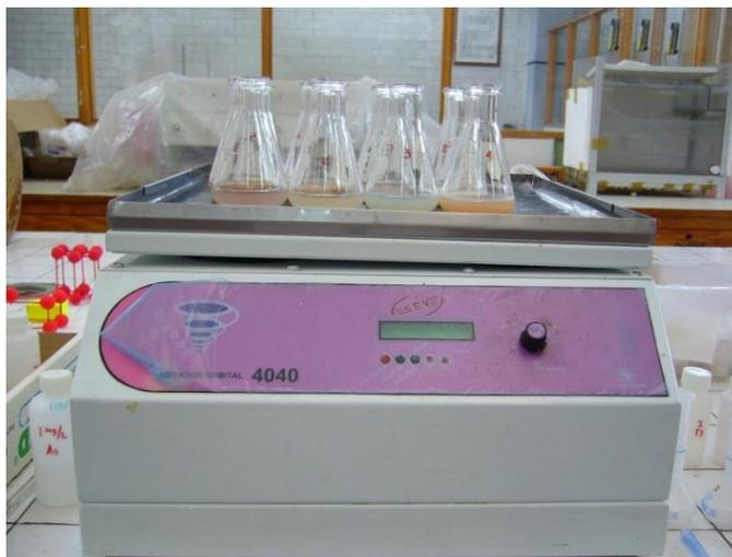
**Figura 11.** Pruebas en batch de los materiales para la remoción de As.
