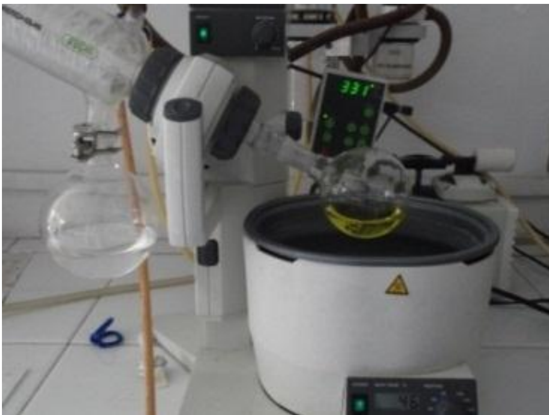
Figura 9. Eliminación del disolvente con rotaevaporador.
