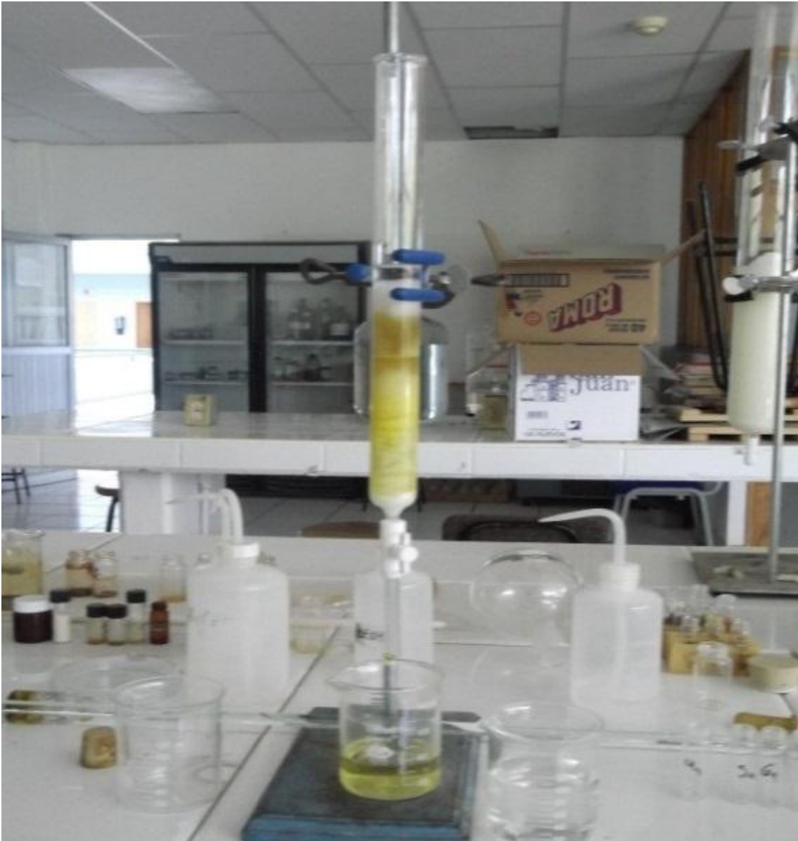
Figura 10. Columna de gel sílica 60 para extracto de hexano.
