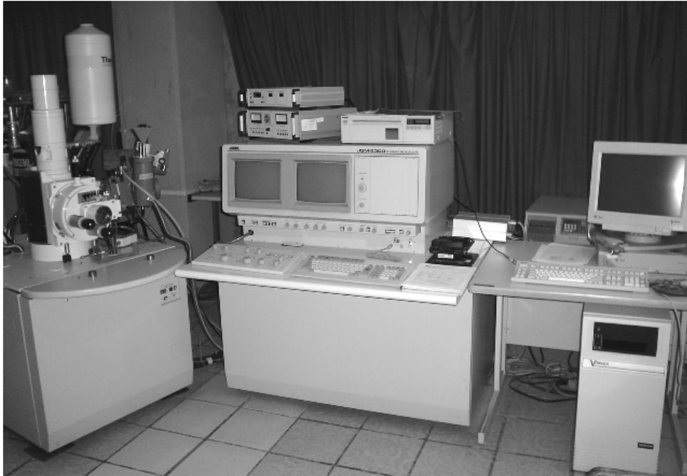
Figura 3.3 Microscopio Electrónico de Barrido (MEB-EDS), JEOL-JSM 6300
