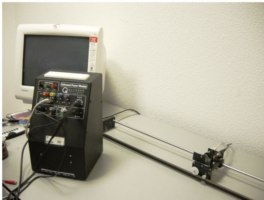
Figura 3.3: Módulo de etapa de potencia VPM-2405
