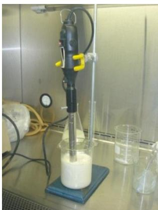
Figura 6.1 Homogeneizador Virtis operado a 5000 rpm
