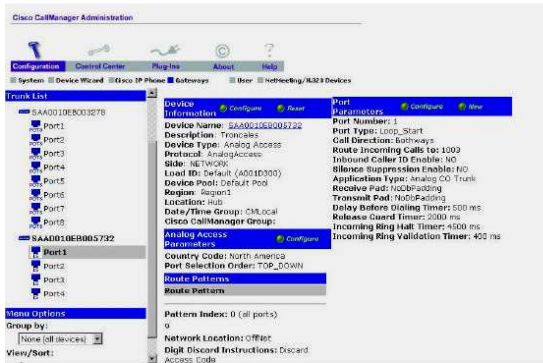
Figura 29. Configuración del Gateway Analógico para líneas troncales
