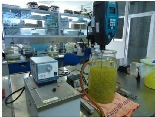
Figura 10. Montaje experimental para la extracción convencional de pectinas de cáscara de tuna.
