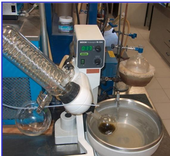
Fig. 2. Evaporación del disolvente de los extractos de las especies en rotavapor.
