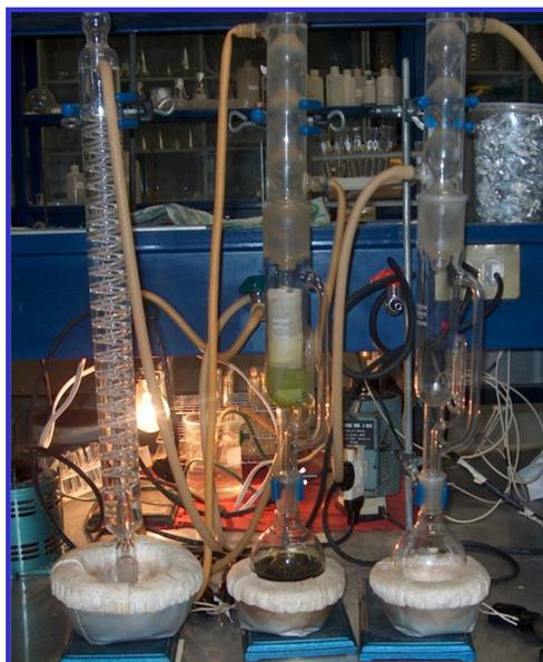
Fig. 1. Extracción por Soxhlet de una muestra de *Senecio*.
