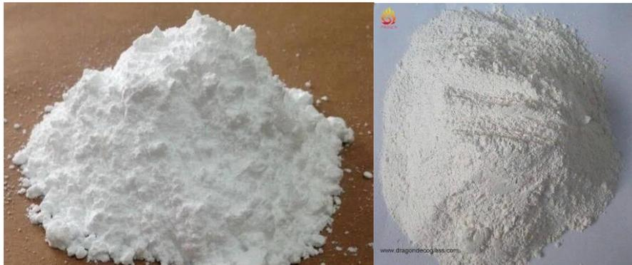
**Figura 1.2.** Dióxido de silicio en polvo (izquierda), silicato de boro (derecha), actualmente dos de los rellenos más usados en las resinas compuestas para restauración dental.
